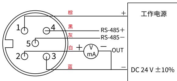
\*请确认产品与连接RS-485之仪器共地，避免接地电压差造成损害。
