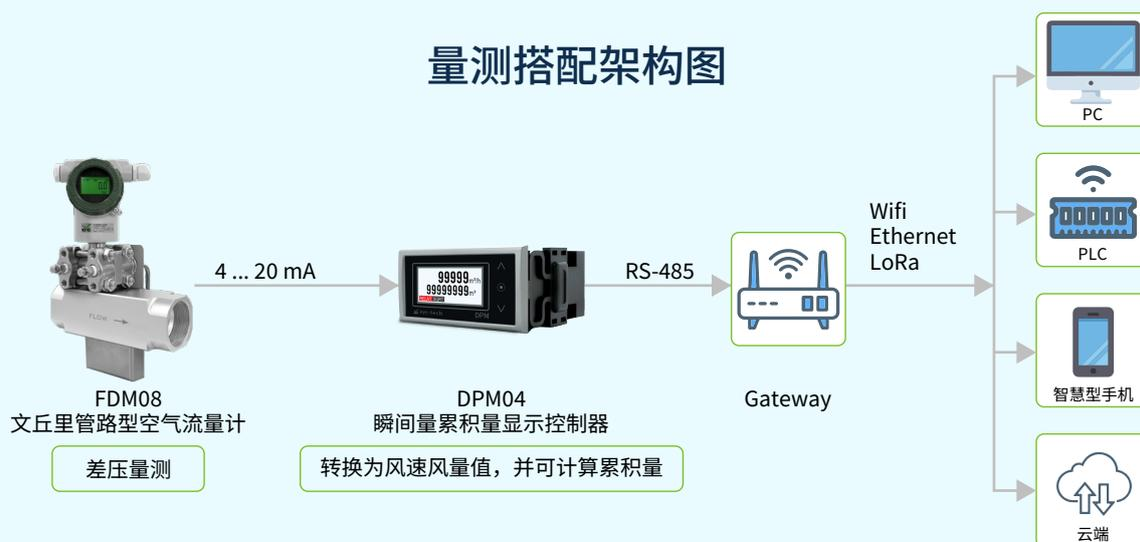
高精度数位化显示、电流电压输入输出、RS-485 通讯、开根号与线性插补等进阶处理功能,为各类传感器整合与工控应用提供稳定可靠的讯号介面。
